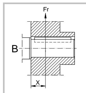
Los elementos de transmisión colocados deben estar equilibrados y no pueden provocar fuerzas radiales ni axiales (para conocer los valores permitidos, consulte el catálogo).
