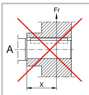
Les éléments de transmission installés doivent être équilibrés et ne doivent pas provoquer de forces radiales et axiales non autorisées (voir le catalogue pour les valeurs admises).
